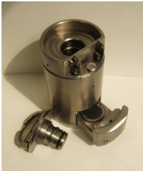
Esta herramienta está diseñada para el manejo de 18FDG radiofarmacos con seguridad absoluta en protección radiológica. Su uso es exclusivo dentro del centro.
